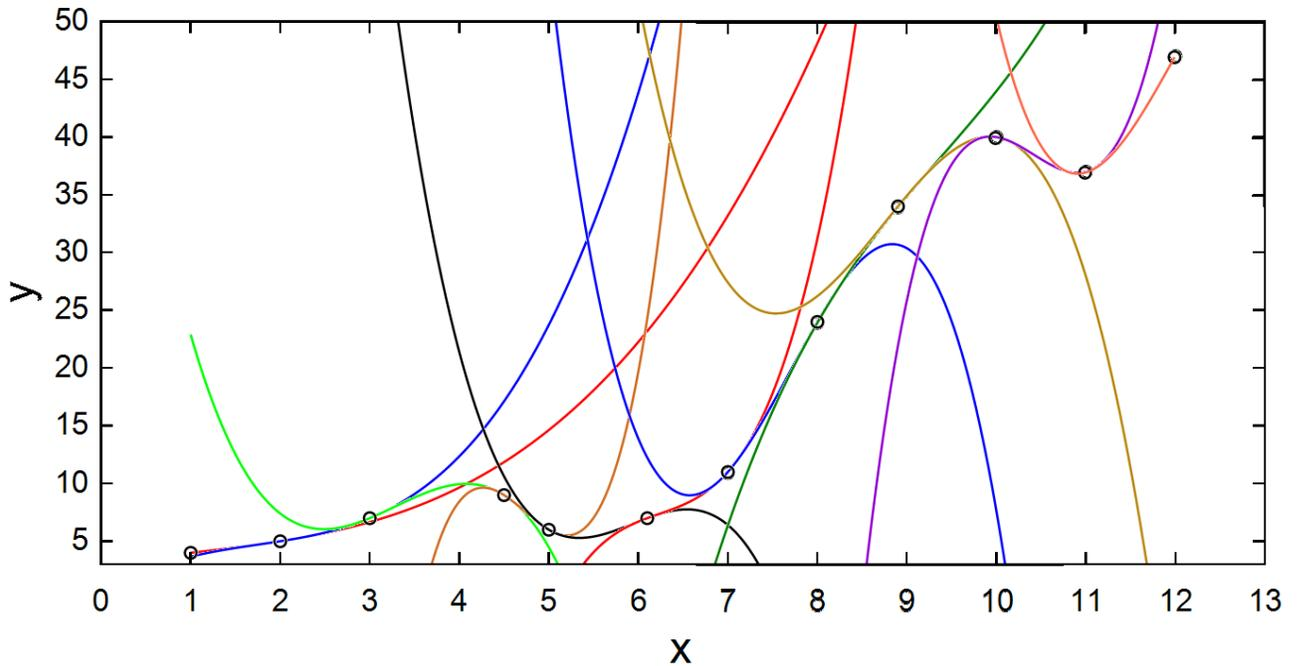
Рис. 6.22. Все кубические параболы, полученные при сплайн-интерполяции
