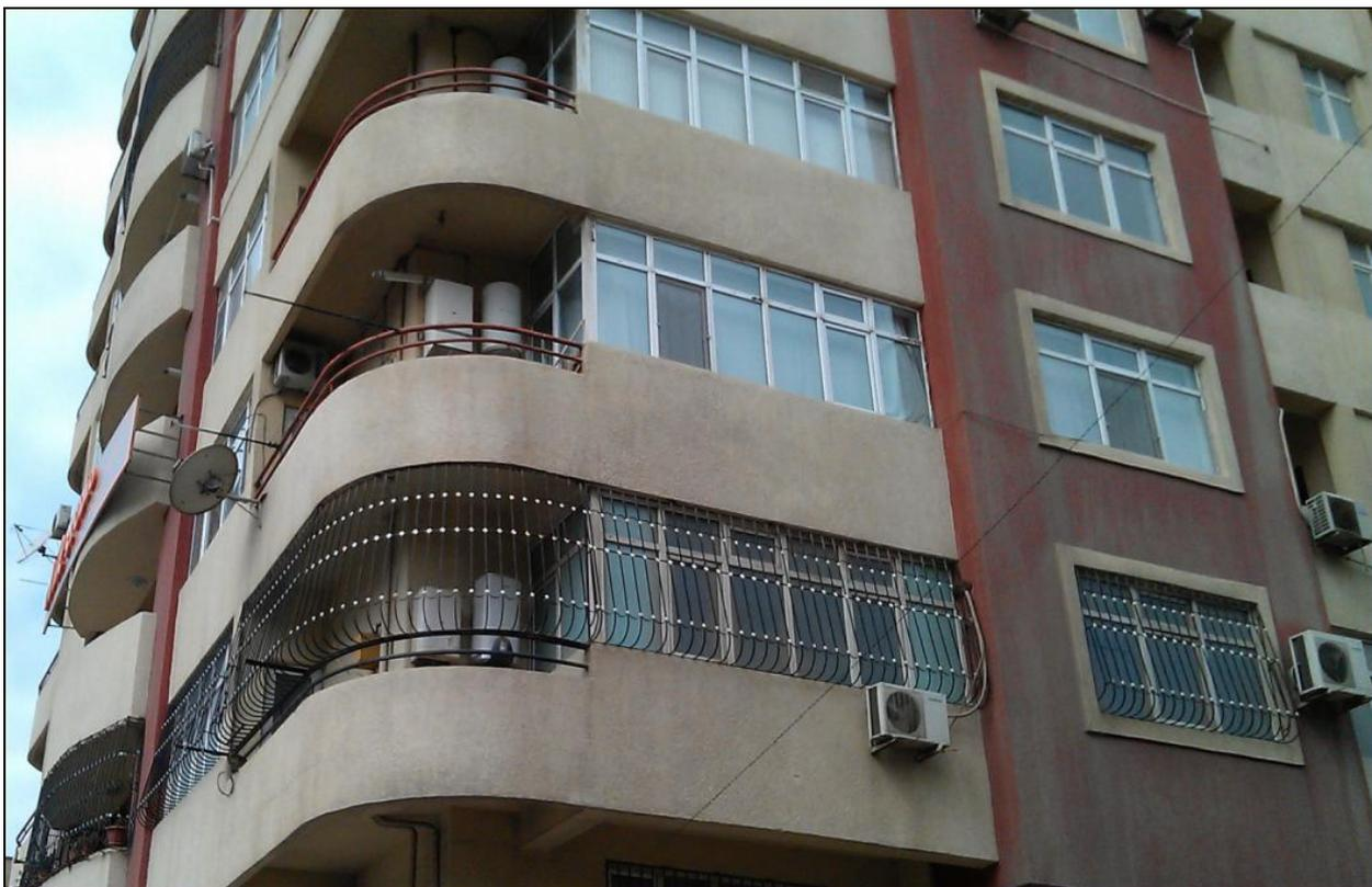
Фото. Мини-котлы на балконе многоквартирного дома, обогревающие отдельные квартиры
